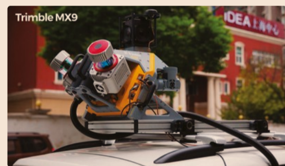
Tecnologie Trimble: rilievo Mobile Mapping con AI per individuare ammaloramenti stradali
