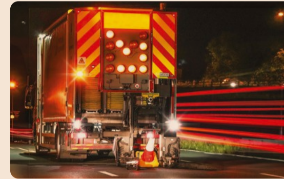
Veicolo automatizzato per la posa e la rimozione dei coni stradali
